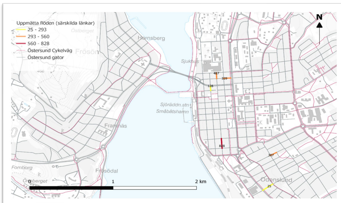
Figur 5. Visar exempel på hur flödesmätningar längs specifika sträckor i en stad kan visualiseras i en karta med olika färger beroende av flödesintervall.
