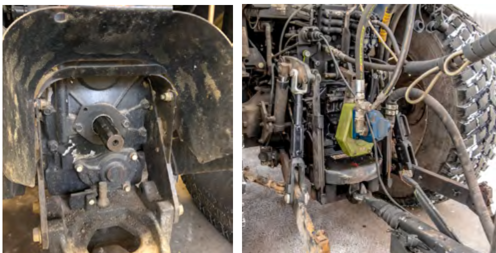
Figur 4. Till vänster ett mekaniskt kraftuttag på en traktor och till höger den specielltillverkade "ryggsäck" som möjliggör hydraulikdrift av borsten med högre varvtal än vad traktorns inbyggda hydraulsystem klarar. Ryggsäcken består av en utväxling (grön), en pump (blå) och en hydrauliktank (sitter i det här fallet på spridarkärran – syns ej i bild). Vilken utväxling som behövs bestäms av vilket arbetsvarvtal traktorn har och vilket varvtal pumpen ska gå med för att uppnå det önskvärda flödet i hydrauliken.
