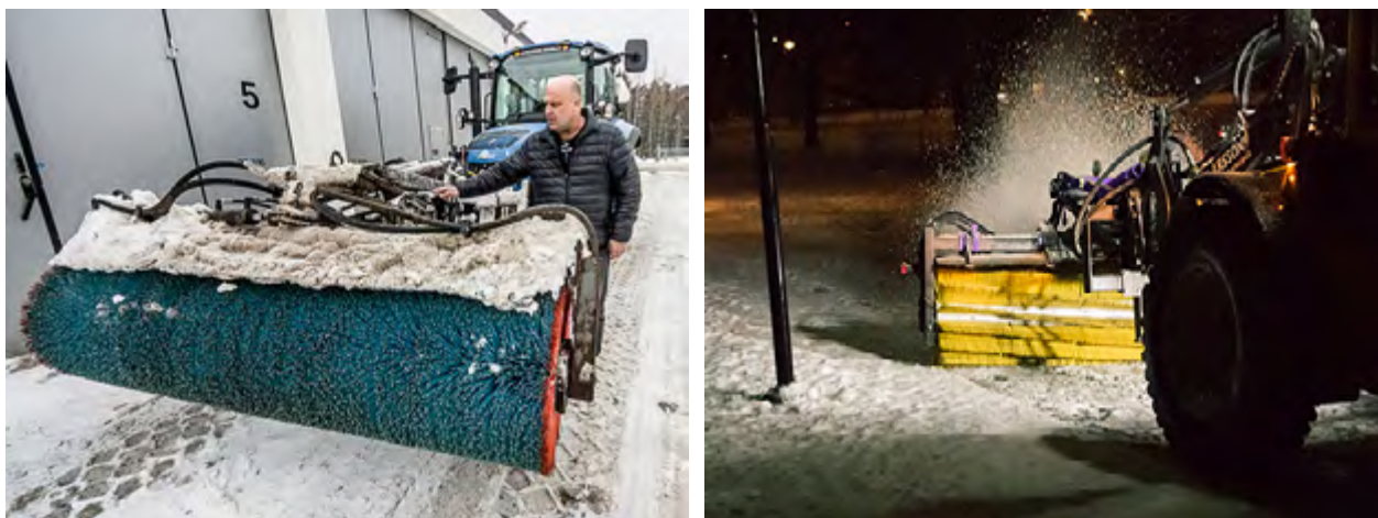
Figur 6. Exempel på sopvalsar. Bilden till vänster: raka borst utan mellanringar ger en tät borste. Bilden till höger: en så kallad "swishborste" där stråna är monterade diagonalt längs sopvalsen istället för som borstringar, tvärs sopvalsen.
