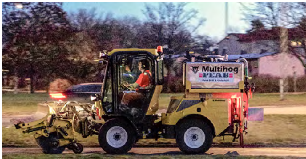
Figur 2. Multihog med borste och plog fram och spridning av saltlösning med dysor bak. Utrustningen på bilden har använts vid sopsaltning av gång- och cykelvägar i Stockholm.
