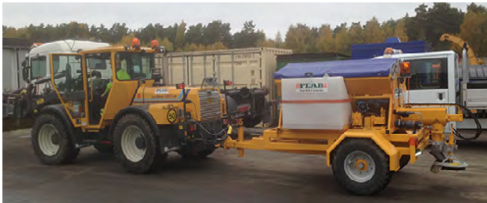
Figur 3. Lundbergare med frontmonterad borste och påhängsvagn med Falköpings tallriks-spridare - en variant av ekipage som använts för sopsaltning av cykelvägar i både Linköping och Stockholm. Foto: Anna Niska.
