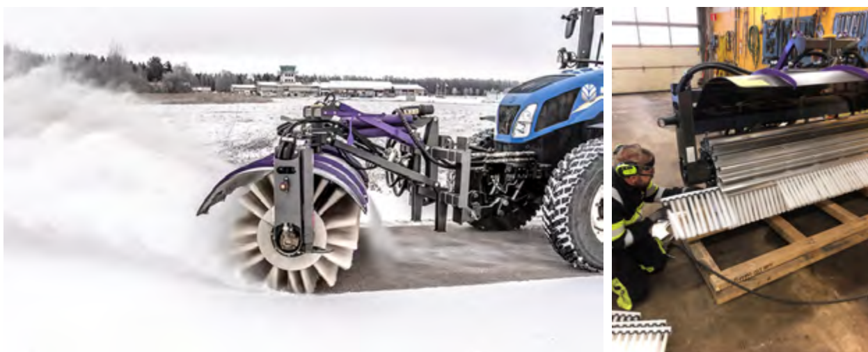
Figur 7. En så kallad kassetborste där stråknippen sitter i kassetter [infälld bild] längs sopvalsen
