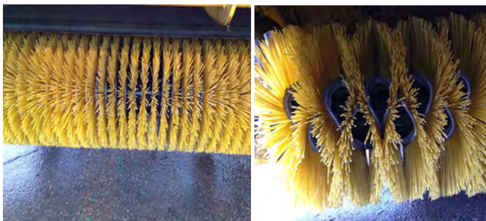
Figur 5. Exempel på borstringar med olika utformning: raka borst med mellanlägg (till vänster), vågade borstringar (till höger).
