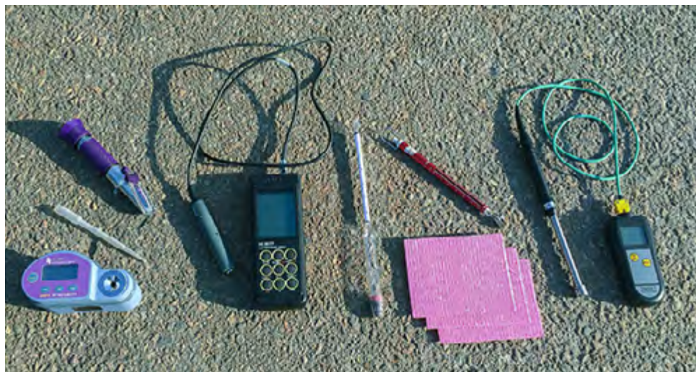
Figur 13. Förslag på en uppsättning av instrument för uppföljning och kunskapsinhämtning inför val av åtgärd. Från vänster: digital refraktometer, optisk refraktometer, elektrisk konduktivitetmätare, hydrometer, fjädervåg och wettextrator för bestämning av vägytans fuktmängd samt en termometer med handhållen yttemperaturgivare för att bestämma vägytans temperatur.
