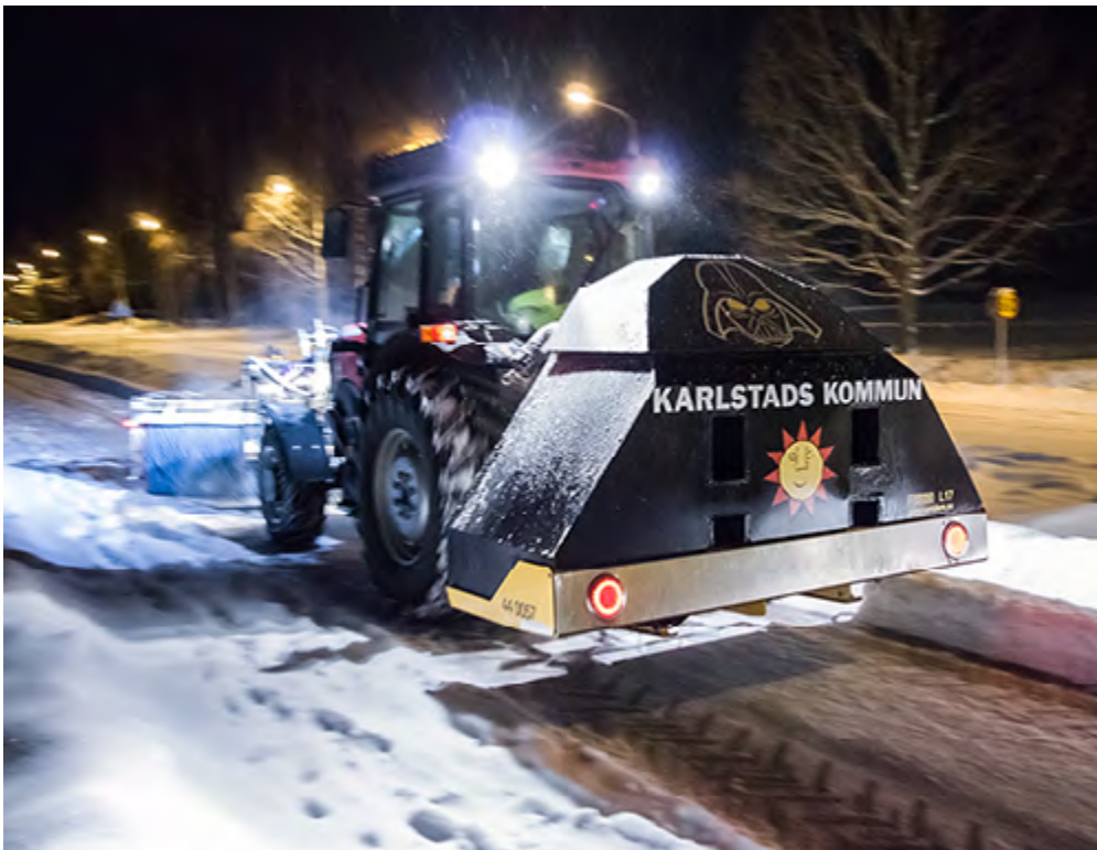
Figur 9. Saltspridare som hänger direkt på traktorns trepunktsfäste.
