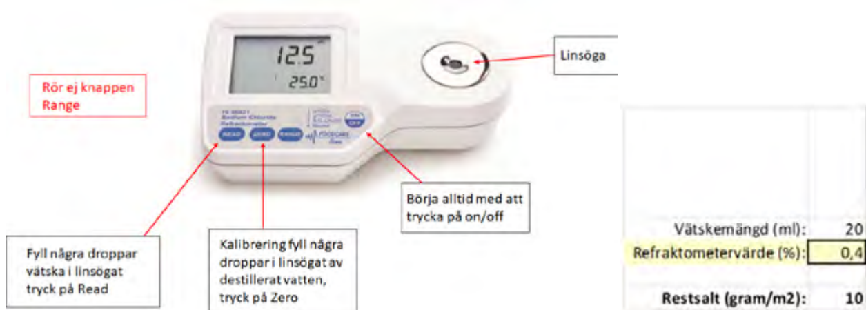
Figur 22. Exempel på en digital refraktometer som kan användas för att bestämma saltkoncentrationen hos en vätska. Till höger visas utsnitt ur beräkningsalgoritm för mängden restsalt i gram per kvadratmeter beroende av tillsatt vätskemängd och uppmätt salthalt (%).
