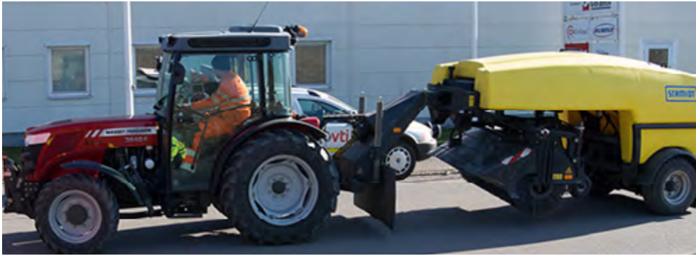
Figur 8. En kombinerad borste och saltspridare i påhängsvagn av typen Schmidt TSS (Towed Sweeper/Sprayer) är ett exempel på variant av spridarvagn med stor tank.
