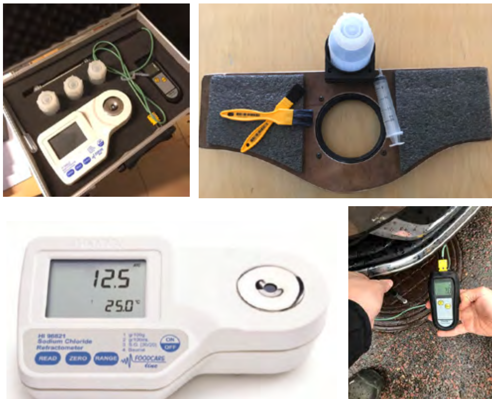
Figur 16. Restsaltmätaren ”Lillgöran”, överst från vänster: tillbehörsväska med instrument och vätskor, saltbrädan med penslar och volymspruta. Nedan från vänster: refraktometer för bestämning av saltkoncentration och termometer med mätbleck som anläggs mot asfaltytan. Foton: Tomas Stomberg.
